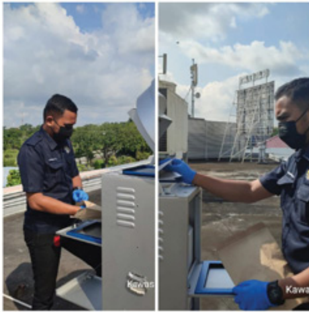
Pengukuran Kualiti Udara Menggunakan Alat High Volume Sampler (HVS)
